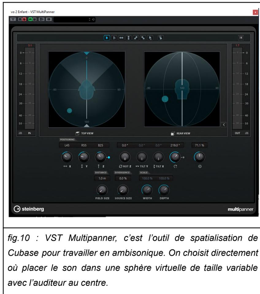
*fig.10 : VST Multipanner, c'est l'outil de spatialisation de Cubase pour travailler en ambisonique. On choisit directement où placer le son dans une sphère virtuelle de taille variable avec l'auditeur au centre.*
