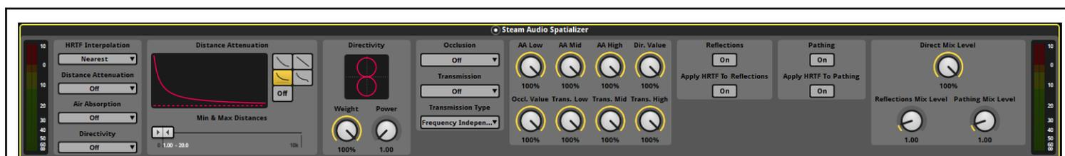
fig.7 : Le plugin de spatialisation Steam Audio développé par Valve, proposant beaucoup plus de paramètres que le plugin natif de Fmod.
